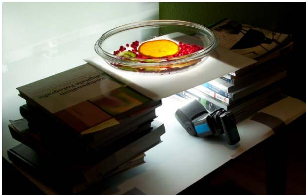
angeordnet sind. Unter der Acrylglasplatte liegt ein Blitz vom Typ Canon 430 EX II, wobei aber jeder China-Blitz genauso gut funktioniert, da die TTL-Funktionalität hier nicht genutzt wird. Der Blitz wird über YN-602-Sender und -Empfänger ferngezündet.
