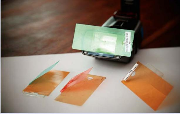
⚡ Die denkbar einfachste Befestigung für Ihre Farbfilter besteht aus selbst zugeschnittenen, angeklebten Kunststoffflaschen aus überzähligen Folien, die Sie dann in den Schlitz der Streuscheibe stecken können. Das hält prima, und Sie benötigen kein Tape oder Klettband.
